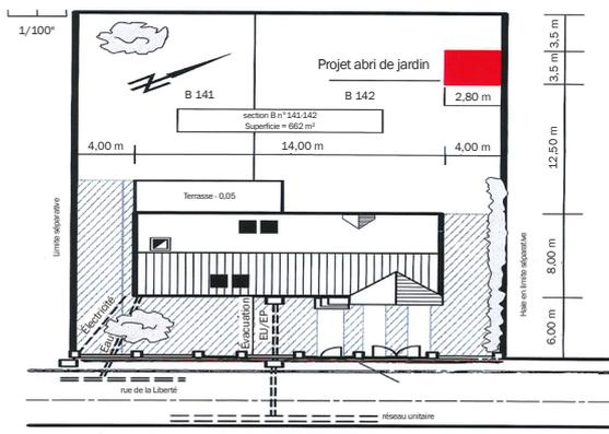
Le plan de masse des constructions à édifier ou à modifier présente le projet dans sa totalité. Il permet de vérifier que les futures constructions respectent les différentes règles d'implantation, y compris par rapport aux constructions existantes, s'il y en a. Il permet également de connaître le projet d'aménagement du terrain, l'organisation des accès à la voie publique.
