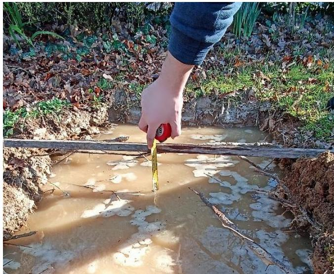
Soit à partir d'une réglette plantée au fond de la fosse (idem, ne pas déplacer la réglette jusqu'à la fin de l'essai) :
